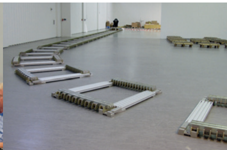
Schienensegmente für den 80 m Fahrweg des SupraTrans II
