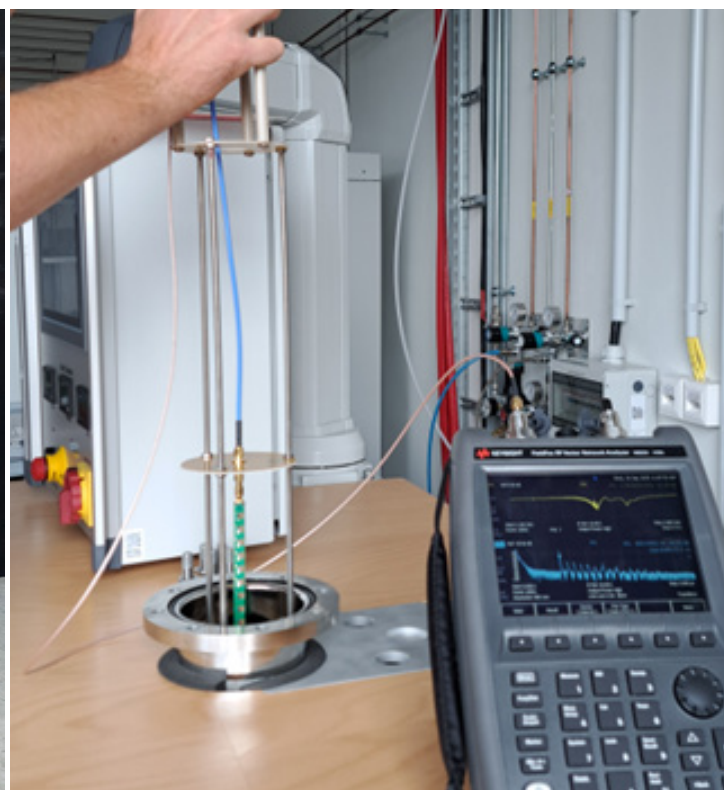
Abb. 3: LH 2 -Testanlage HyLiqEASY installiert und betriebsbereit im Wasserstofflabor der TU Dresden (links). Prototyp eines neuen kryogenen Füllstandsmessgeräts auf Basis der SAW-Technologie ist in die LH 2 -Testkammer eingesetzt (Thomas Windisch und Hagen Schmidt, IFW Dresden). Fig. 3: LH 2 test facility HyLiqEASY installed and ready for operation in the hydrogen lab of the TU Dresden (left). Prototype of a new cryogenic level meter based on SAW technology is inserted into the LH 2 test chamber (Thomas Windisch and Hagen Schmidt, IFW Dresden).
