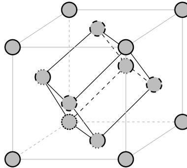
Abbildung 2.13: Das reziproke Gitter des kubisch raumzentrierten Gitters ein kubisch flächenzentriertes Gitter.
