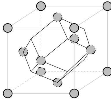
**Abbildung 2.14:** Brillouin-Zone des kubisch raumzentrierten Gitters. Die Einheitszellen sind im reziproken Raum, das reziproke Gitter ist kubisch flächenzentriert.
