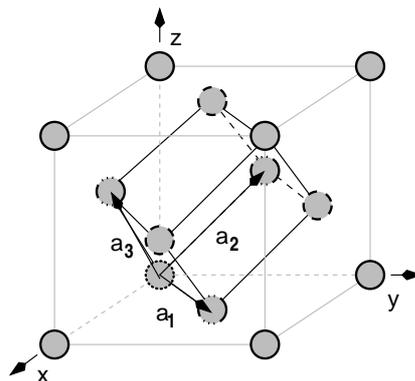
**Abbildung 2.15:** Die primitive Zelle des kubisch flächenzentrierten Gitters ist ein Rhomboeder. Die primitiven Translationen  $\vec{a}_1$ ,  $\vec{a}_2$  und  $\vec{a}_3$  verbinden den Gitterpunkt am Ursprung mit den Gitterpunkten in den Flächenmittelpunkten.
