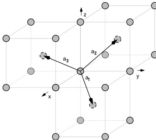
**Abbildung 2.12:** Primitive Translationen des kubisch raumzentrierten Gitters; diese Vektoren verbinden den Gitterpunkt am Ursprung mit dem Gitterpunkt in der Würfelmittelpunkt. Die primitive Gitterzelle erhält man aus diesen Achsen ein vollständiges Rhomboeder aufbaut.
