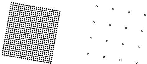
Hier gezeigt ist ein Kristall, der leicht gedreht ist. Sein Abbild, das reziproke Gitter ist in die selbe Richtung gedreht, wie der Kristall im Ortsraum.
