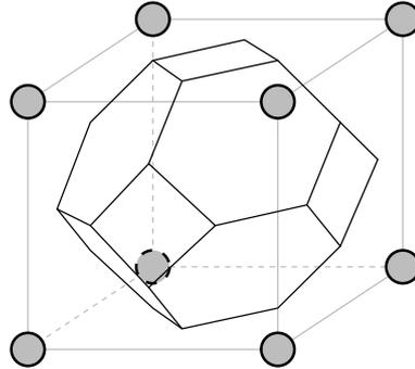
**Abbildung 2.16:** Brillouin-Zone des kubisch flächenzentrierten Gitters. Die Einheitszellen sind im reziproken Raum, das reziproke Gitter ist kubisch raumzentriert.
